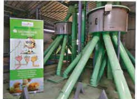
Un distributeur revolver oriente les graines sur le process adapté (huit destinations possibles) afin d'obtenir la protéine valorisée attendue.
