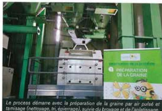
Le processus démarre avec la préparation de la graine par air pulsé et tamisage (nettoyage, tri, épierrage), suivie du broyage et de l'aplatissage.
